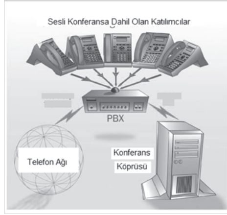
Resim 4.5: Sesli konferans sisteminin çalışması
